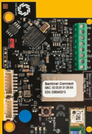
Sentinel Connect è la scheda intelligente che permette di controllare l'impianto nebbiogeno direttamente dal computer grazie al software, scaricabile dal sito [concept-italy.com](http://concept-italy.com), tramite App o portale dedicato.
